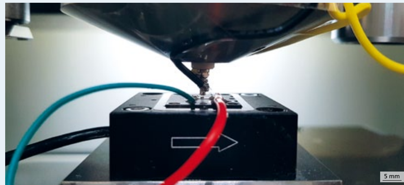
1 Versuchsaufbau mit Positionierer (unten) und der Belastungseinheit am Nanoindenter (oben).
